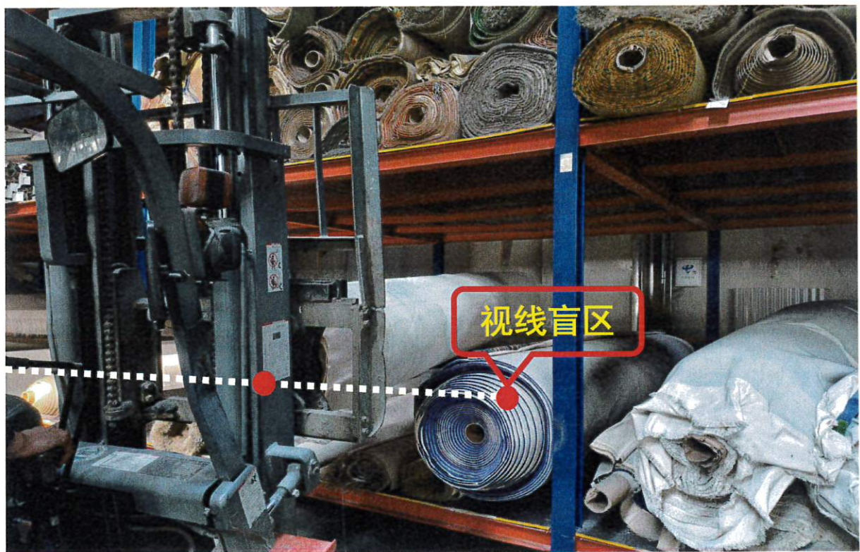
“6.27” 车辆伤害事故叉车作业人员视线盲区
